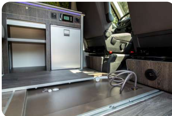
PLATO DE DUCHA CON AGUA CALIENTE A GAS INTEGRADO EN EL SUELO DE MADERA CONTRACHAPADA
