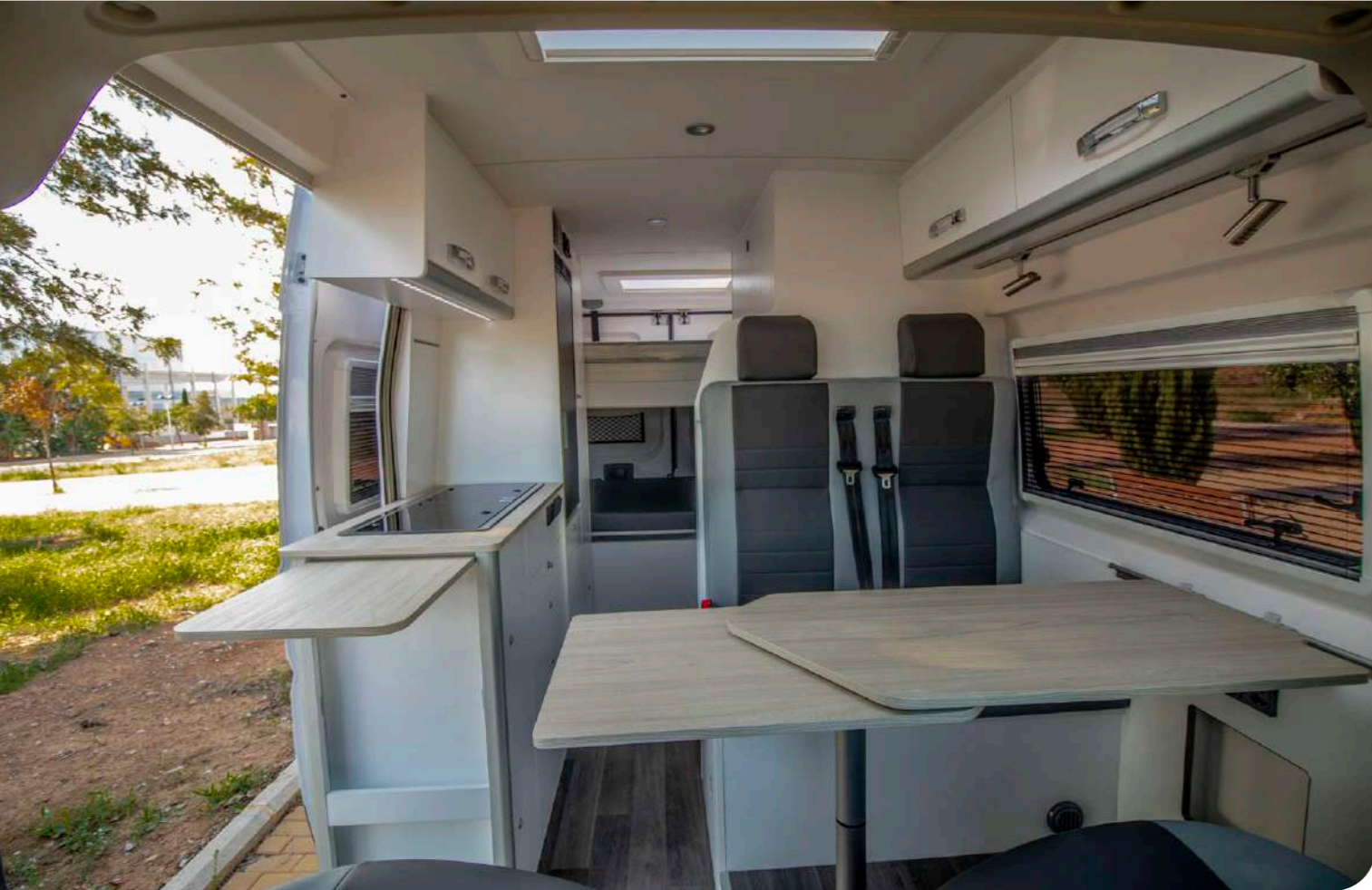
MUEBLE DE MADERA CONTRACHAPADA APLACADA EN HPL CON EL ESPACIO DE ALMACENAJE APROVECHADO AL 100%
