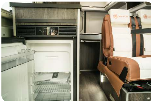
NEVERA DE 70 LITROS CON CONGELADOR Y APERTURA LATERAL PARA FÁCIL EXTRACCIÓN DESDE EL INTERIOR / EXTERIOR
